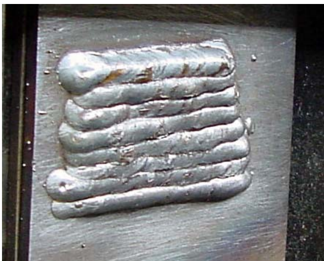
Figura 4 – Camada realizada com fonte inversora em modo MIG/MAG
