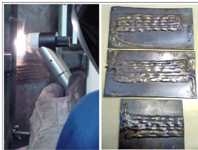
Figura 10 – Depósitos iniciais com a tocha PTAP manual
