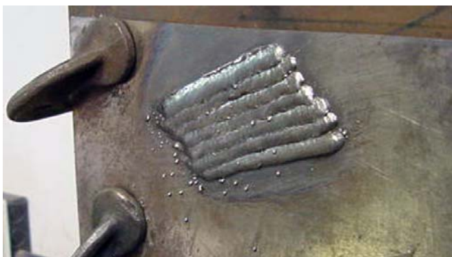
Figura 3 – Camada depositada com os parâmetros da Tabela 3 e variáveis individuais conforme o oscilograma da Figura 1
