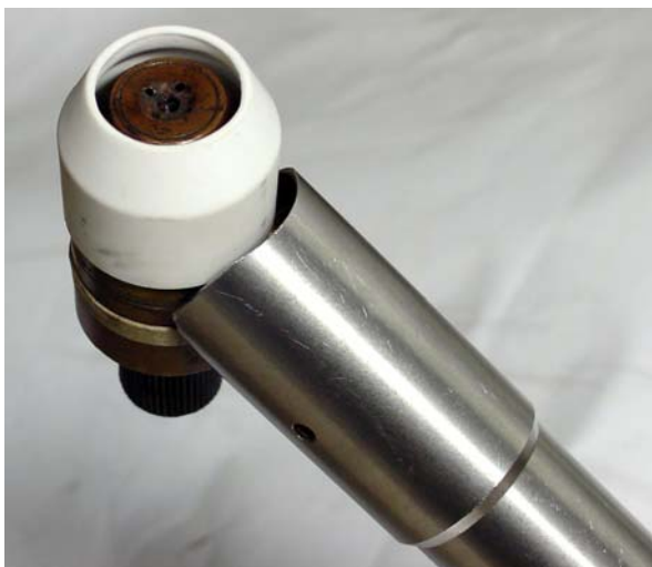
Figura 8 – Tocha PTAP comercial para operação manual com 4 vias de vazão de pó
