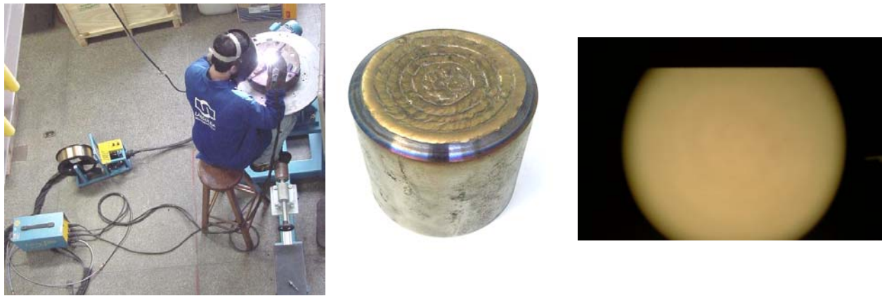
Figura 6 – Bancada para soldabrasagem TIG, peça revestida e radiografia.
