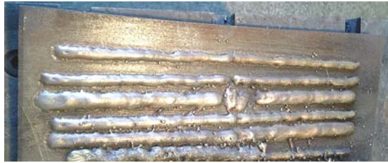
Figura 3 – Depósitos realizados com o processo MIG, relativos à Tabela 1.
