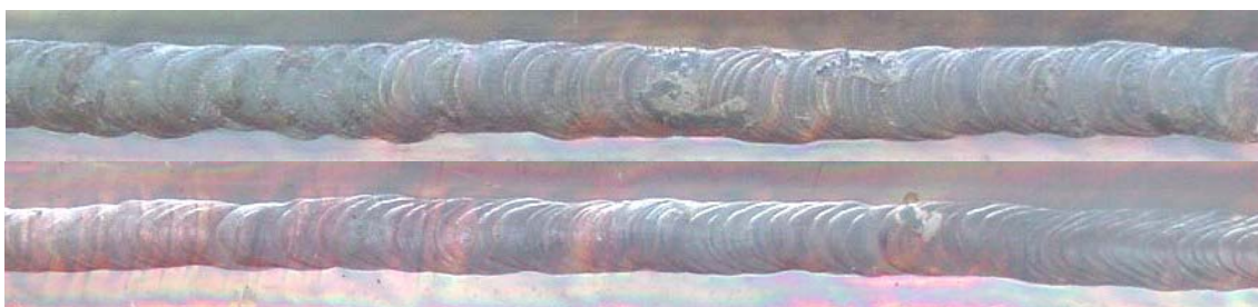
Figura 4 – Cordões realizados com adição de material na forma de varetas
