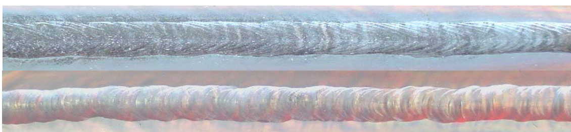
Figura 5 – Cordões realizados com adição de material na forma de arame
