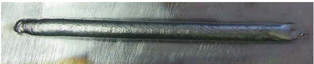
Fig. 7.23 – Cordão de Solda de Aço Inoxidável 309-L Confeccionado na Posição Sobrecabeça com mistura de Ar + CO 2 no Gás de Proteção
