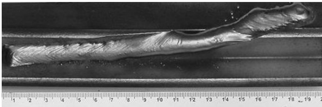
Figura C.8 - Aspecto visual do cordão de solda resultante do ensaio COMP8.
