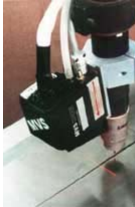
Figura 2.3 - Sistema de seguimento de junta com tecnologia LASER (Metatech, 2000).
