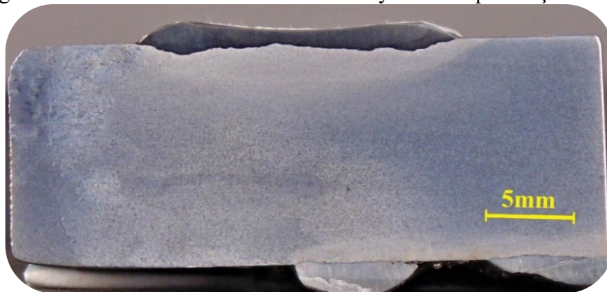
Figura 76 - Cordão único realizado de Stelloy 6 em chapa de aço carbono
