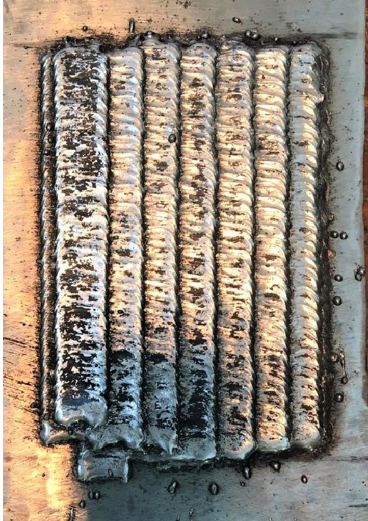
Figura 73 - Duas camadas de revestimento com Stelloy 6 sob a chapa de CA6NM
