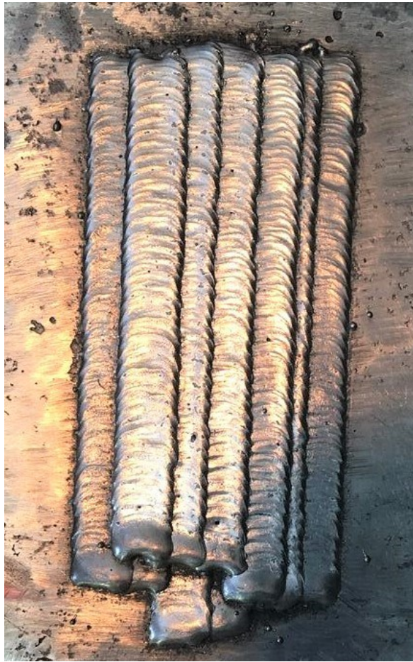
Figura 83 - Revestimento com Durolit 21 de duas camadas com amplitude de oscilação de 12 mm em CA6NM
