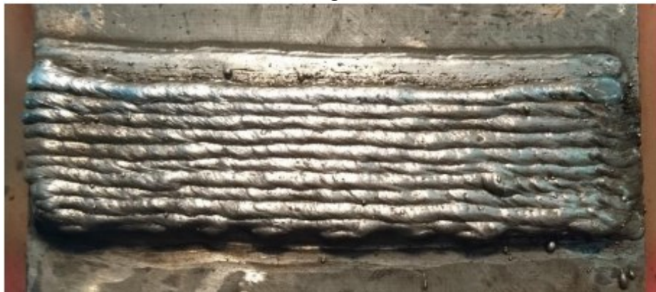
Figura 45 - Segunda camada de revestimento com Cavitalloy sobre a camada de amanteigamento
