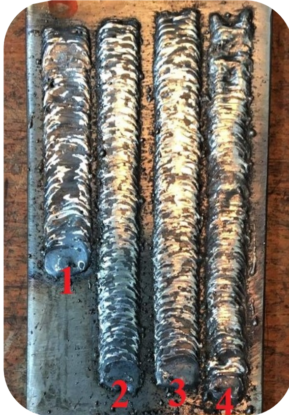
Figura 62 - Cordões (chapa B) realizados com Cavitalloy
