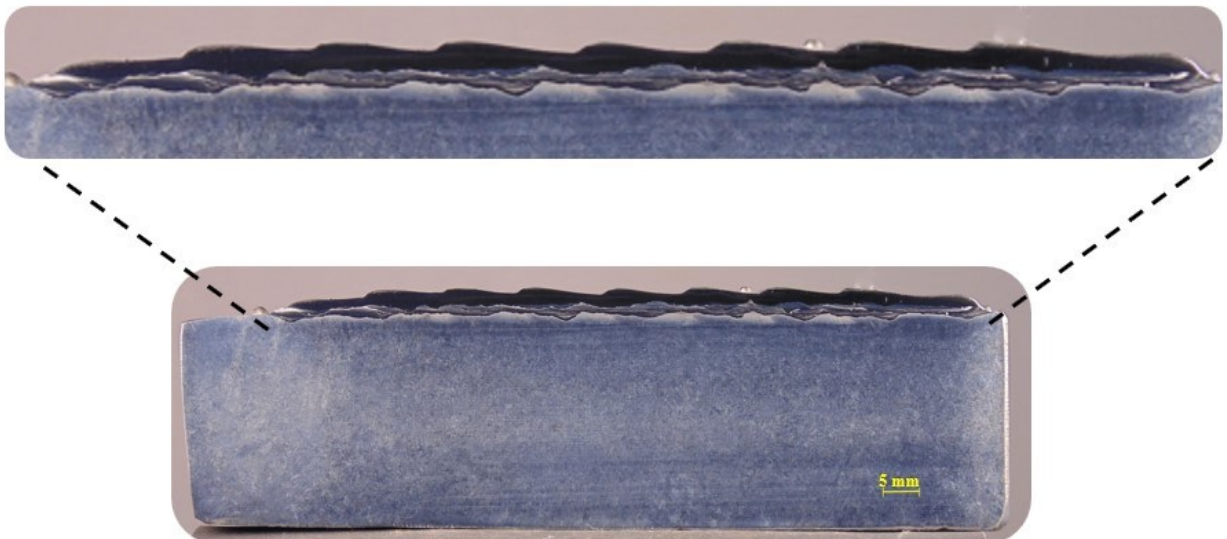
Figura 88 - Macrografia do revestimento de 15 mm de amplitude na chapa de CA6NM para Durolit 21
