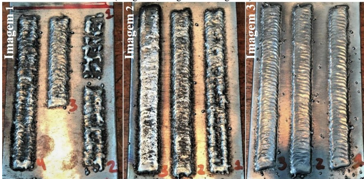
Figura 68 - Sequência da parametrização dos cordões de solda realizados com Stelloy 6 (Imagem 1, imagem 2 e imagem 3)
