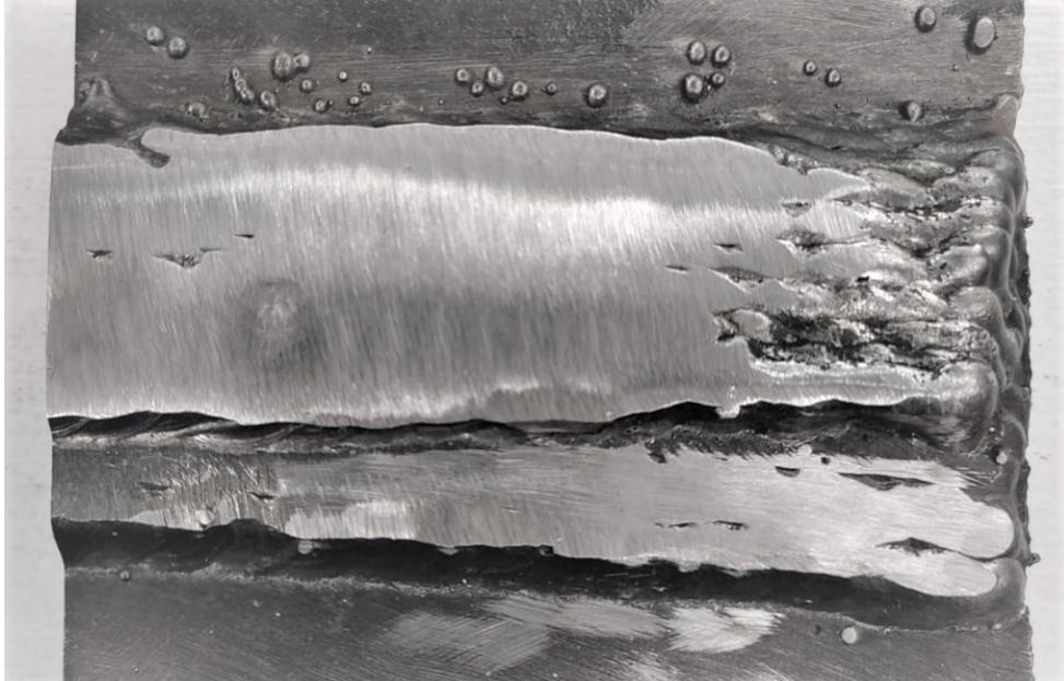
Figura 51 - Revestimento com duas camadas de Durolit 21 sobre chapa de CA6NM
