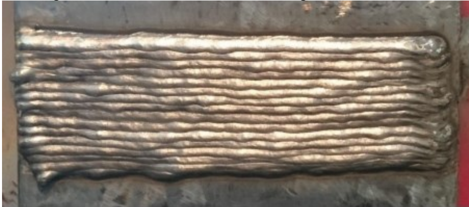
Figura 44 - Primeira camada de amanteigamento com E309L
