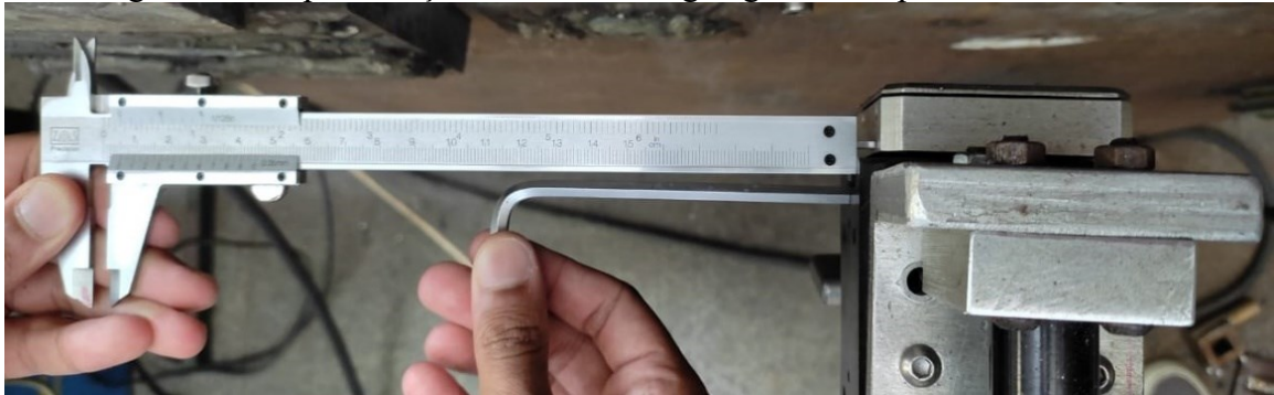
Figura 43 - Representação do modo de regulagem da amplitude do oscilador
