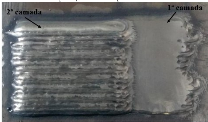
Figura 47 - Revestimento de duas camadas com Stelloy 6 utilizando Argônio puro como gás de proteção sobre chapa de CA6NM
