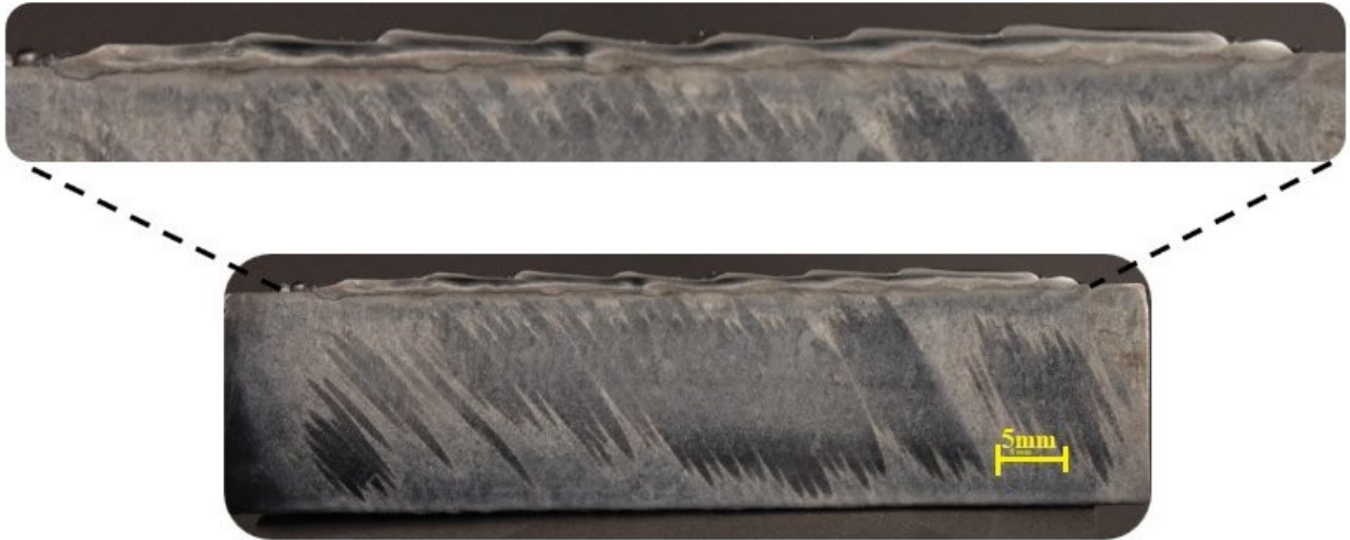
Figura 78 - Macrografia do revestimento com Stelloy 6 na chapa de CA6NM
