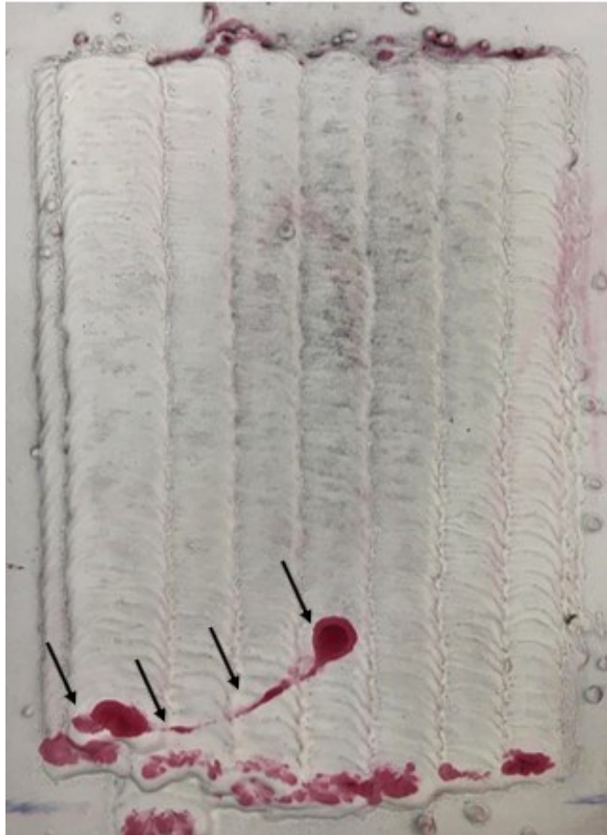
Figura 74 - Ensaio de liquido penetrante sob o revestimento na chapa de CA6NM com Stelloy 6
