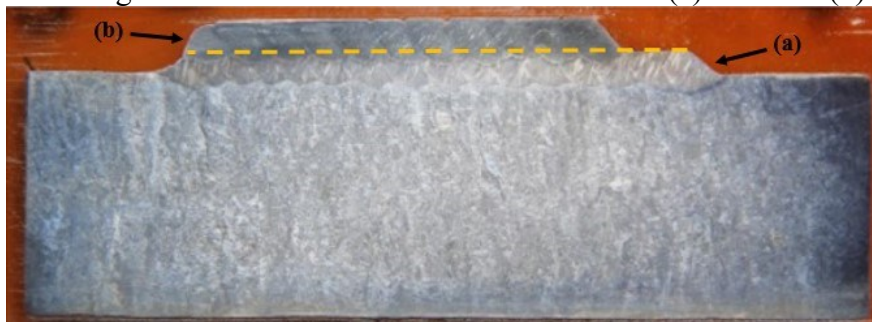
Figura 46 - Macrografia do revestimento com duas camadas. (a) E309L e (b) Cavitalloy
