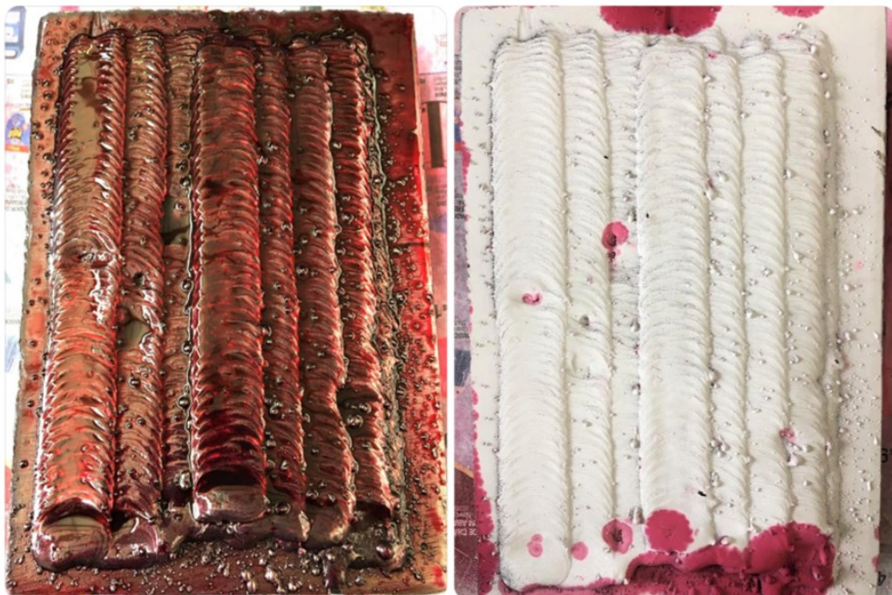
Figura 65 - Ensaio de líquido penetrantes para averiguação do aparecimento de trincas
