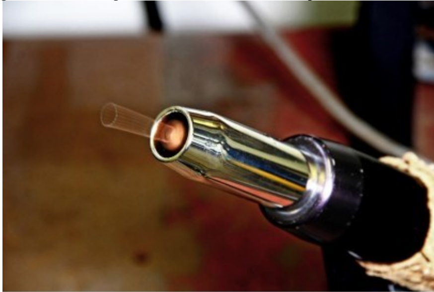
Figura 18 - Tocha Spinarc rotacionada em alta frequência. W = 3000 rpm
