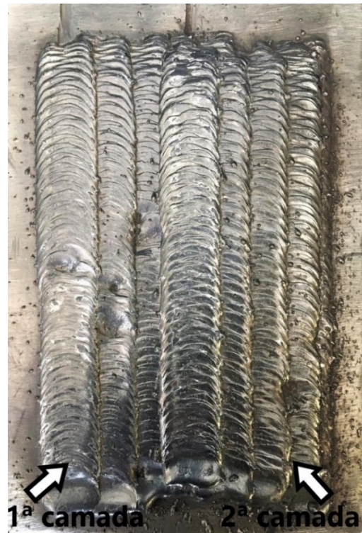
Figura 64 - Revestimento com 1 camada e 1/2 na chapa de CA6NM
