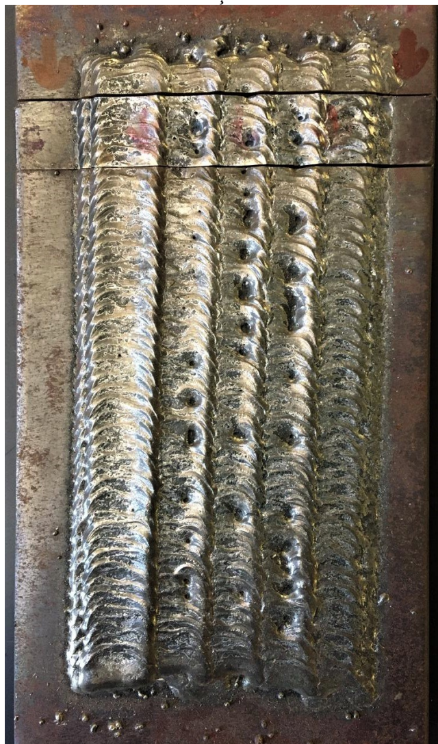
Figura 80 - Revestimento com Durolit 21 de duas camadas com amplitude de oscilação de 15 mm em aço carbono
