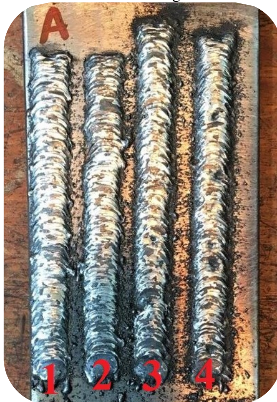
Figura 61 - Cordões (chapa A) realizados com Cavitalloy; 1 e 2 – Convencional, 3 e 4 – Pulsado Sinérgico
