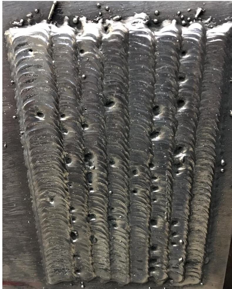
Figura 81 - Revestimento com Durolit 21 de duas camadas com amplitude de oscilação de 15 mm em CA6NM
