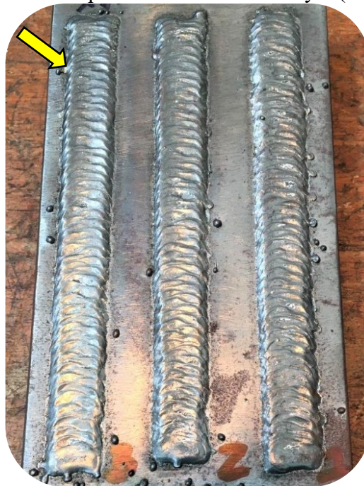
Figura 69 - Cordão padrão utilizando Stelloy 6 (seta amarela)
